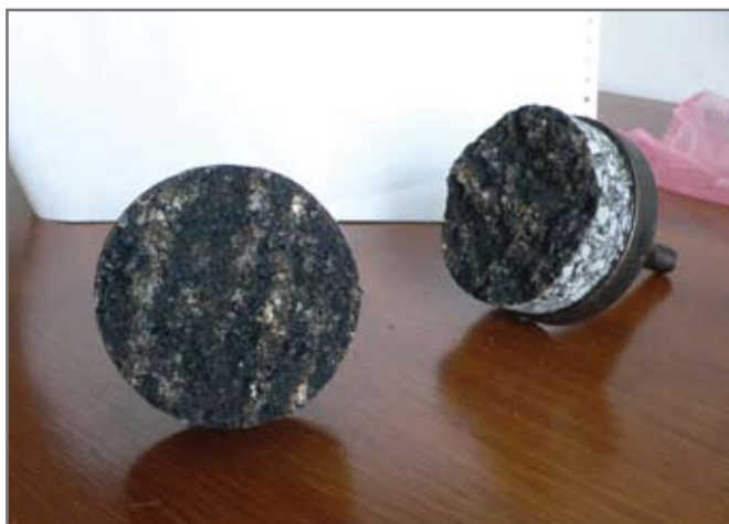
1. ábra: A húzóvizsgálat eredménye szerint a rétegek közötti tapadás nem megfelelő. A kopóréteg és az alatta fekvő réteg határfelületén jól látható a durva barázdáltság és a ragasztóanyag hiánya.
